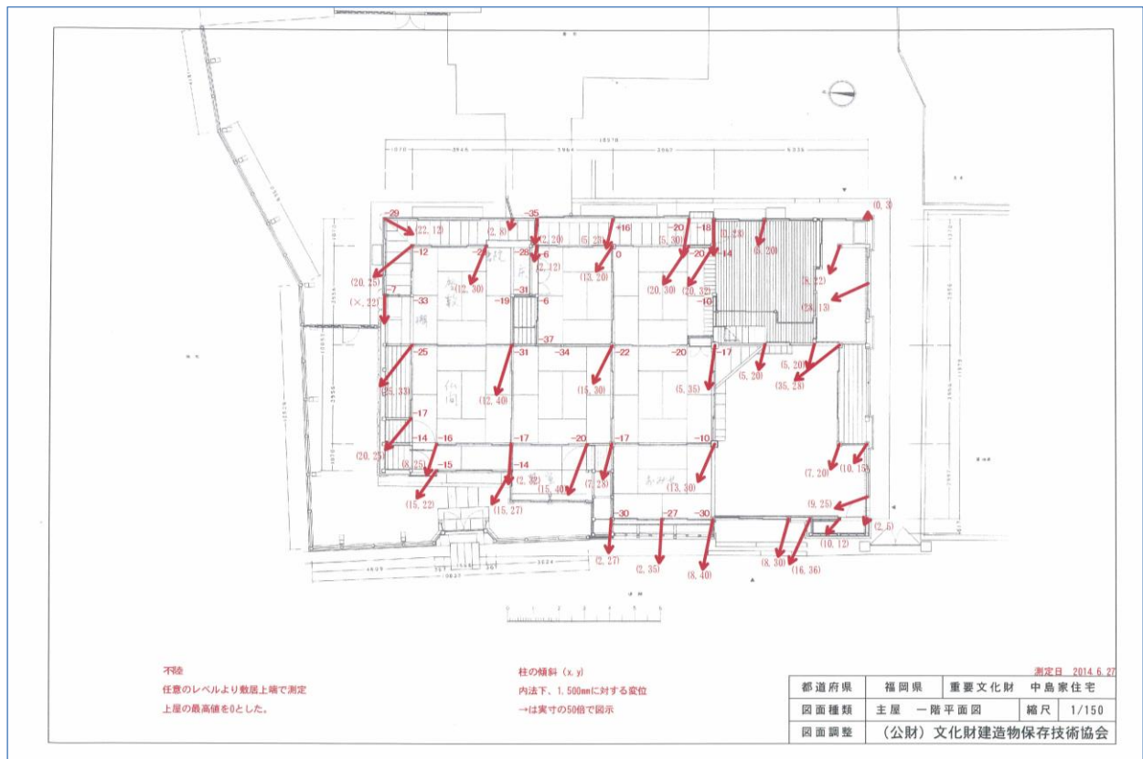
調査の結果、判明した母屋の傾きを表す図(最大 傾き37mm)
