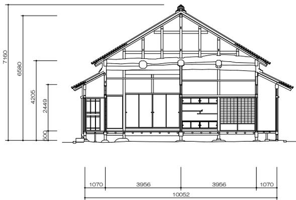
図表 12 中島家住宅主屋梁間断面図「座敷部分」
